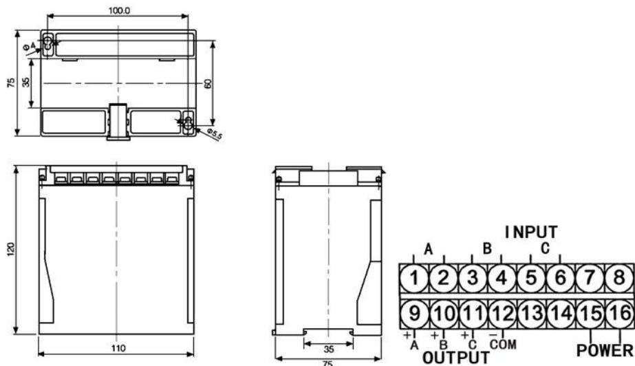
端子标准: 5.08mm, 16pin 接线式连接器
